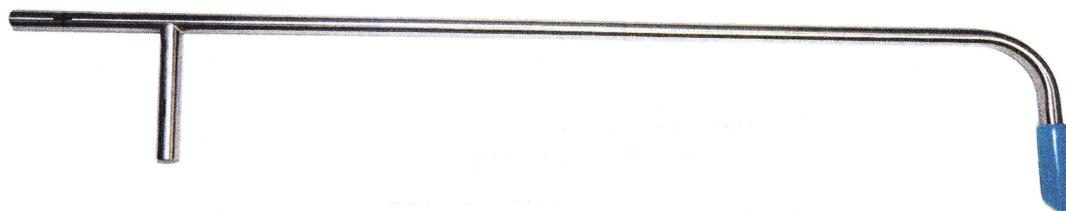
Рисунок 1 - Общий вид трубок дифференциальных testo модификации «Пито-Прандтля»
